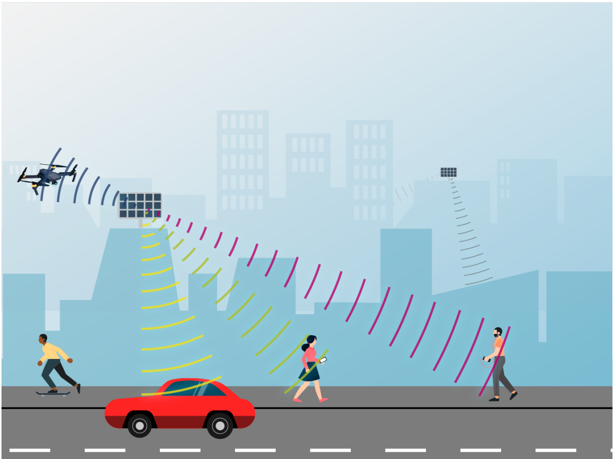
Illustration 2: Les antennes adaptatives envoient spécifiquement des données dans la direction du terminal, source OFCOM 19
